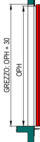
SEZIONE PORTE SENZA TELAIIO (EI120)
