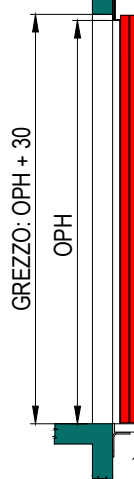
SEZIONE PORTE SENZA TELAIO (E1120)
