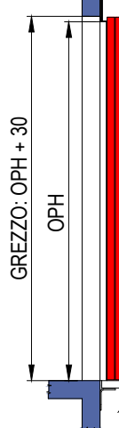
SEZIONE PORTE SENZA TELAIIO (EI120)
