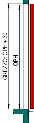
SEZIONE PORTE SENZA TELAIO (EI120)
